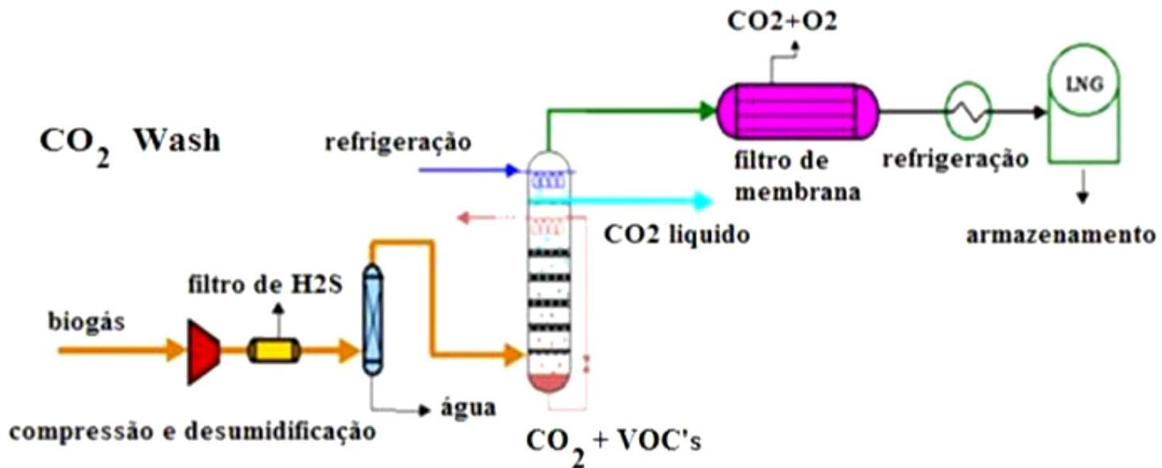
Esquema de purificação (CO<sub>2</sub>Wash).
