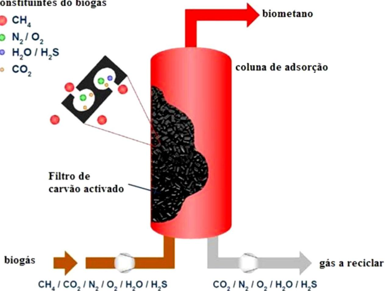
Esquema de captação de impurezas do biogás PSA
