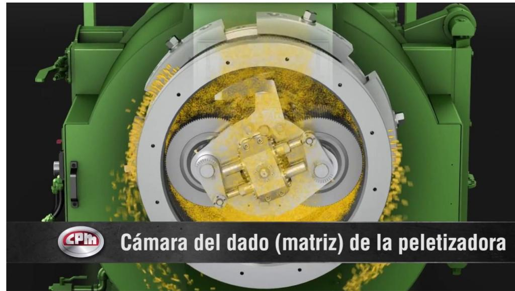
Figura: Modelo de peletizadoras.
