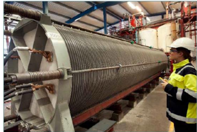
Eletrolisadores NEL (tecnologia Norsk Hydro BP)
