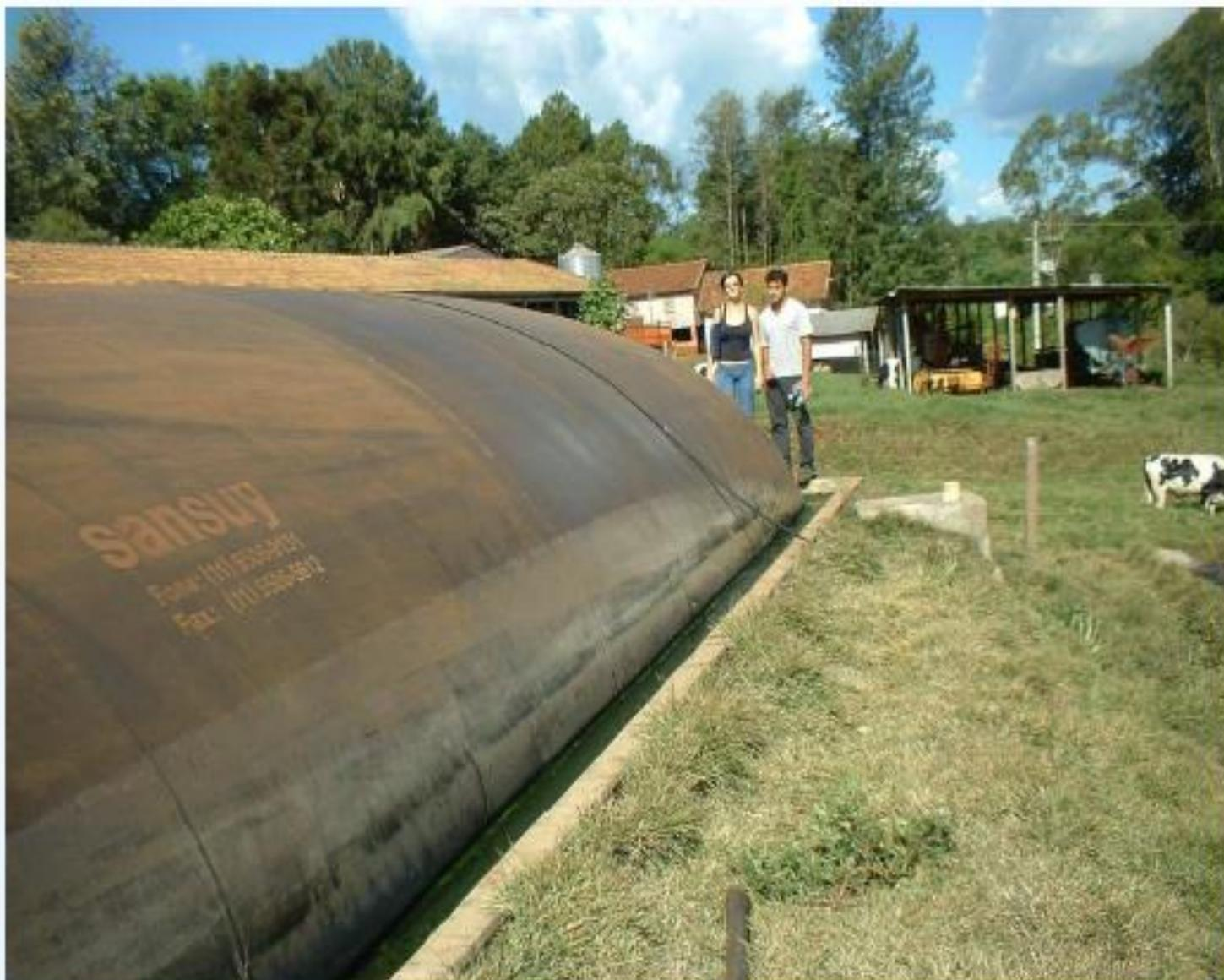
Figura 8: Biodigestor Tubular utilizando dejetos de Suínos — Mansueto Bombardelli, em Toledo-PR.
