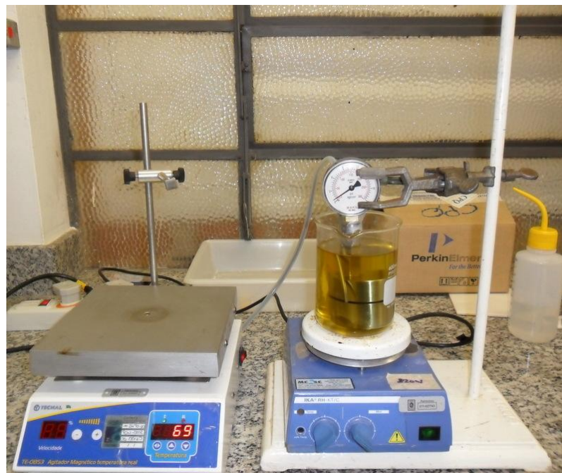
FIGURA 17 - REATOR E SISTEMA ADAPTADO COM BANHO DE ÓLEO. FONTE: O AUTOR
