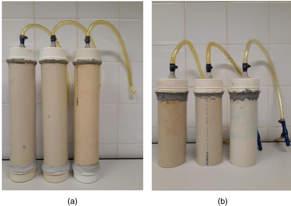
FIGURA 5 – (a) REATORES E (b) GASÔMETROS UTILIZADOS NA CODIGESTÃO ANAERÓBIA
