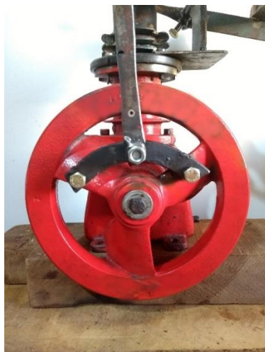
FIGURA 16: PONTO DE FIXAÇÃO DO MECANISMO DE ACIONAMENTO NA POLIA
