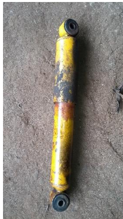
FIGURA 11: AMORTECEDOR DE AUTOMÓVEL
