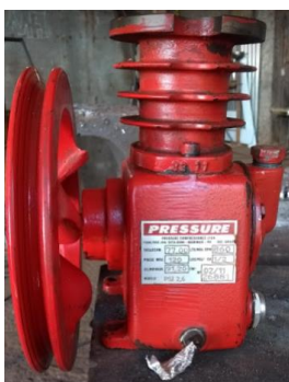
FIGURA 10: CABEÇOTE DE COMPRESSOR DE AR
