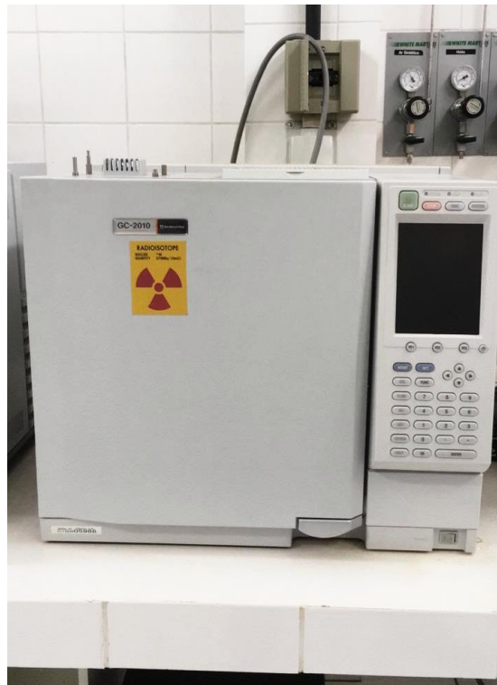
FIGURA 9 – CROMATÓGRAFO A GÁS PARA AVALIAR A COMPOSIÇÃO DO BIOGÁS
